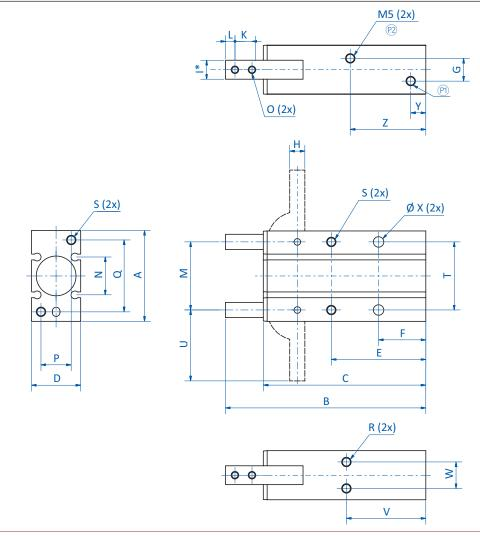
\* = Toleranz: -0,005 mm bis -0,025 mm 🔞 = Druckluftanschluss (Öffnen) 🕲 = Druckluftanschluss (Schließen)
